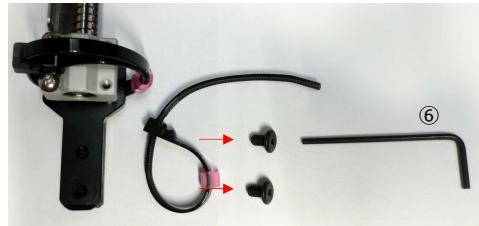
2. ③ノブで①タングステンプローブを②ワッシャー 2枚ではさみこむようにして取付けます。
